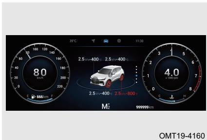
Переключиться на экран системы контроля давления воздуха в шинах можно нажатием кнопки "◀" или "▶" на рулевом колесе.
