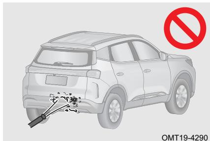
Для нормальной работы системы сигнализации при парковке поверхность датчиков следует регулярно очищать от снега, грязи пыли. Пользуйтесь для этого мягкой тканью или струей воды под низким давлением.
