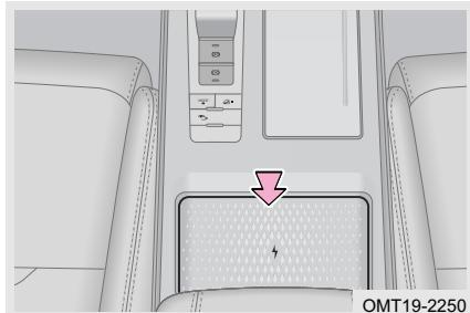
Установите выключатель пуска двигателя в положение ON. Беспроводное зарядное устройство начнет работать после того, как вы положите мобильный телефон на зарядную поверхность. На дисплее аудиосистемы появится символ "充满". После полной зарядки мобильного телефона на дисплее аудиосистемы появится символ "充满".
