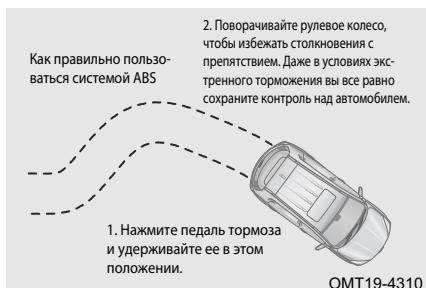
Антиблокировочная тормозная система (ABS) вступает в действие только при опасности блокировки колес при торможении, но не во время нормального торможения. Если во время торможения педаль тормоза пульсирует и слышен шум, это указывает на работу системы ABS. Такие пульсации и шум являются нормальным явлением. Не отпускайте педаль тормоза.
