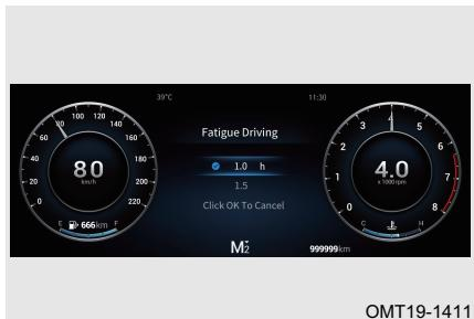
Шаг 1. При выведенном на дисплей экране настройки нажмите на верхнюю или нижнюю сторону кнопки подтверждения, пока не отобразится экран индикатора усталости водителя. Коротко нажмите кнопку подтверждения для перехода на экран предупреждения о неисправности.
