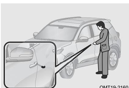
Шаг 2. Вставьте механический ключ в замок двери водителя и поверните его по часовой стрелке, чтобы отпереть дверь, или против часовой стрелки, чтобы запереть дверь.
