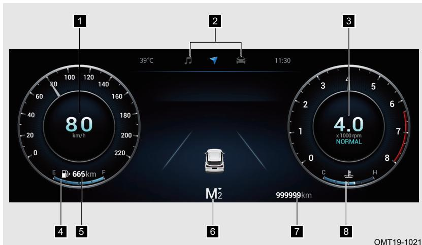
1 Спидометр служит для отображения скорости движения автомобиля в км/ч.
