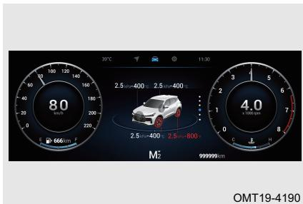
Если температура воздуха в шинах превышает 85 °C и автомобиль при этом некоторое время движется со скоростью, превышающей 30 км/ч, система подаст предупреждение о высокой температуре воздуха в шинах. Во время подачи предупреждения о высокой температуре воздуха в шинах мигает символ соответствующего колеса, отображается текущее значение температуры воздуха в шине и на приборной панели загорается желтый сигнализатор «».
