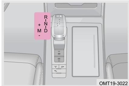
Доступны следующие положения селектора: P, R, N и D в режиме автоматического переключения и M (+, -) в режиме ручного переключения. Текущее положение селектора отображается на информационном дисплее на приборной панели.
