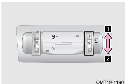
Переключатель корректора фар имеет 4 положения (0, 1, 2 и 3), которые следует выбирать в зависимости от количества пассажиров и багажа в автомобиле.
