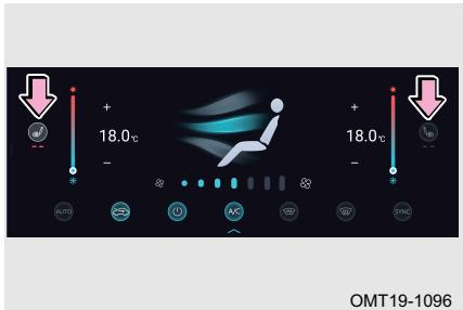
При первом нажатии на выключатель включается вторая ступень нагрева (- загораются оба индикатора). При втором нажатии на выключатель включается первая ступень нагрева (- загорается один индикатор). При третьем нажатии на выключатель обогрев выключается.
