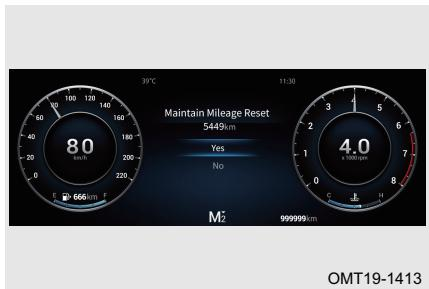
Шаг 1. При выведенном на дисплей экране настройки нажмите на верхнюю или нижнюю сторону кнопки подтверждения, пока не отобразится экран сброса интервала технического обслуживания. Коротко нажмите кнопку подтверждения для перехода на экран сброса интервала технического обслуживания.
