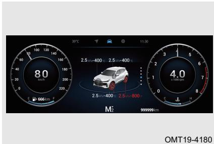
Если давление воздуха в шинах опустилось ниже 1,75 бар и автомобиль при этом некоторое время движется со скоростью, превышающей 30 км/ч, система подаст предупреждение о низком давлении воздуха в шинах. Во время подачи предупреждения о низком давлении воздуха в шинах мигает символ соответствующего колеса, отображается текущее значение давления воздуха в шине и горит желтый сигнализатор «» на приборной панели.
