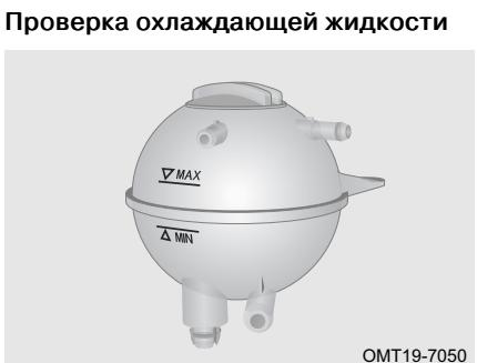
На холодном двигателе уровень охлаждающей жидкости должен находиться между метками MIN и MAX. Если уровень охлаждающей жидкости опустился до отметки MIN или ниже ее, долейте охлаждающую жидкость в бачок и незамедлительно обратитесь на сервисную станцию официального дилера для проверки и ремонта автомобиля.
